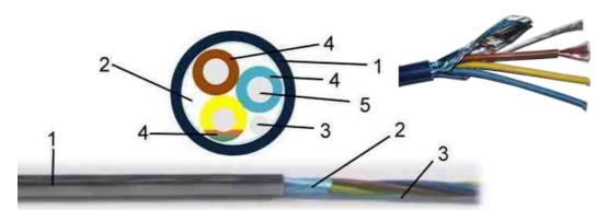
FRNC = Flame Retardant Non Corrosive = Flame retardant per IEC-332-1 test standard
